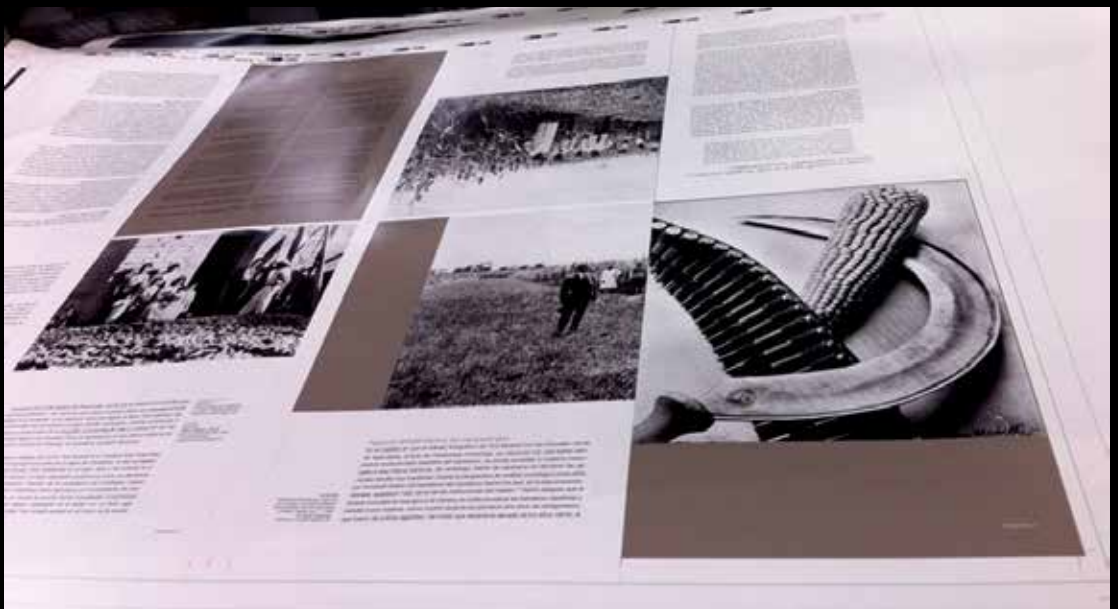
Arriba: placa de offset . Abajo: pliego impreso. VoBo a pie de máquina, (2014).
