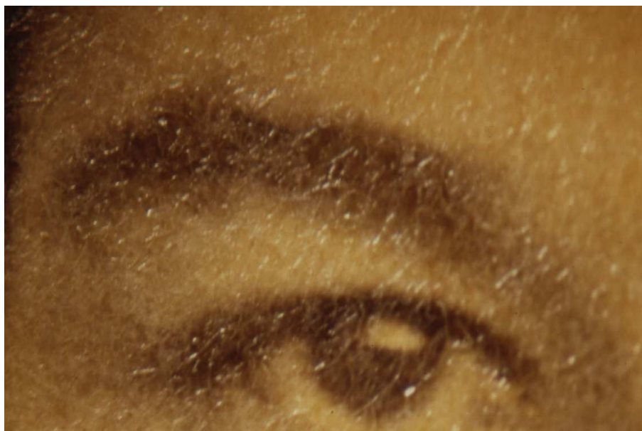
Imagen 16. Vista al microscopio de albúmina estable
