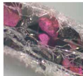
Filtro de carbón activado con permanganato de potasio (corte transversal de Purafilter 16X) (<URL:<http://www.purafil.com>>).
