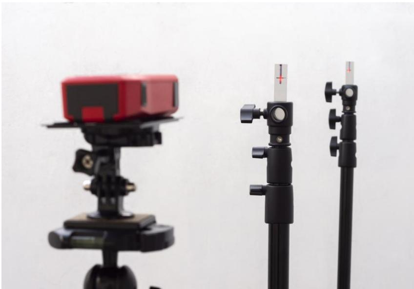
*Figura 15: Alineación de la guía de cámara.*
