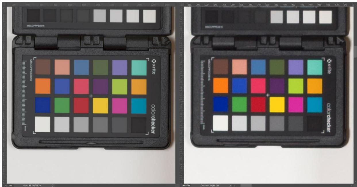
*Figura 35: ColorChecker en la imagen combinada (izquierda) y en toma única (derecha).*
