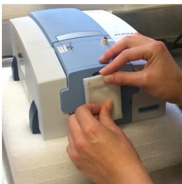
**Imagen 61. Colocación de la muestra de gelatina sobre polímero en el módulo de reflexión frontal del espectrómetro Alpha II marca Bruker del laboratorio CODICE de la CNCPC - INAH.**
