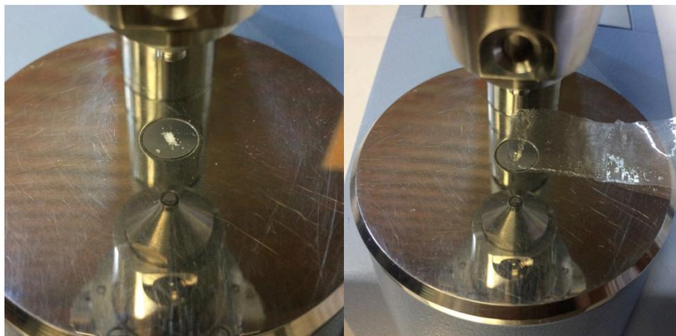
**Imagen 60. Muestras de gelatina granulada y en película en el módulo ATR del espectrómetro Alpha II marca Bruker del laboratorio CODICE de la CNCPC - INAH.**
