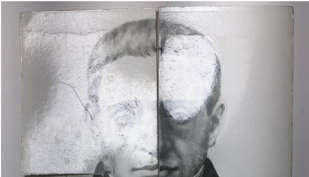
**Imagen 81. Lado izquierdo: luz especular en la fotografía tratada con Éviter®, se nota un menor brillo y un manchado. Lado derecho: luz especular en la fotografía de referencia se nota un brillo homogéneo en la superficie.**
