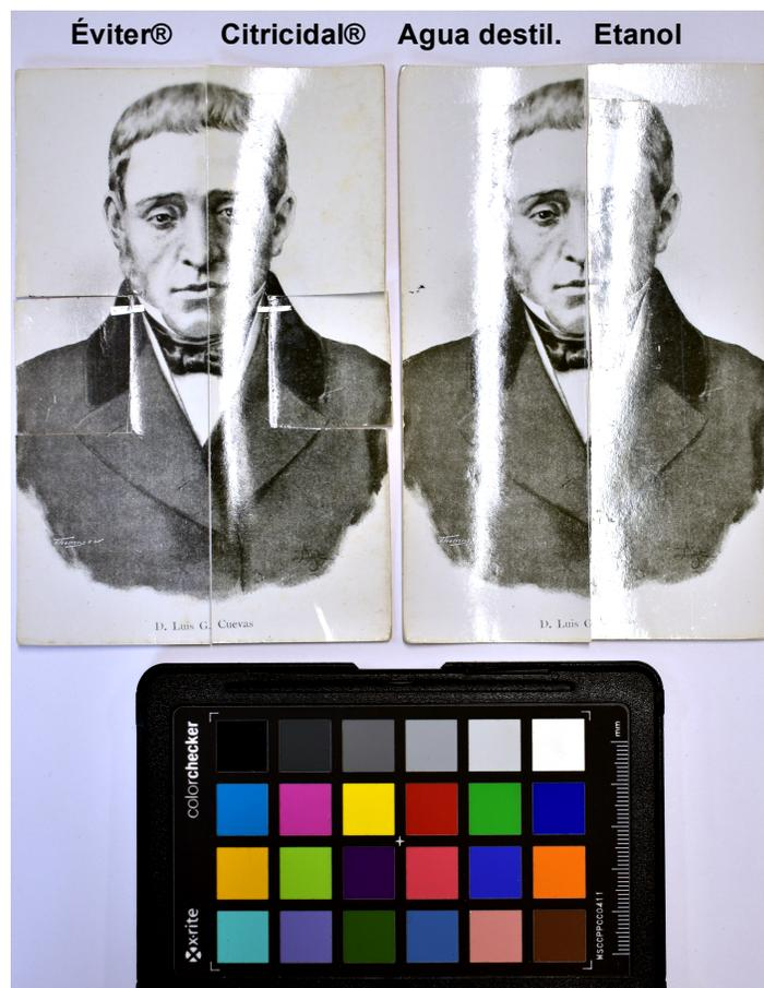
Imagen 83. Medición de colores en las impresiones después de la aplicación de los productos. La fotografía con Éviter® se nota menos amarilla que las demás, situación evidente sobre todo en los grises. En las zonas blancas con Citricidal® se nota un mayor amarillamiento que en las demás probetas.
