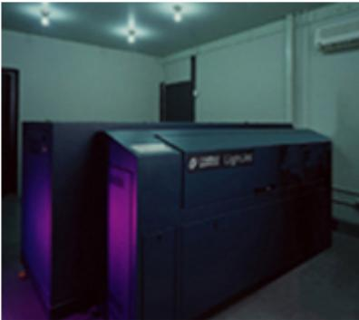
El grabador de película digital utiliza tecnología de láser para "dibujar" la imagen sobre la superficie de la película. La resolución se incrementa al manipular los puntos que conforman la imagen y el número de píxeles que forman la imagen.
