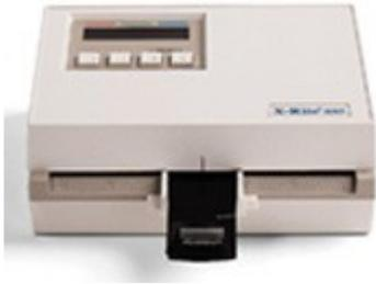
Las densidades en una fotografía se miden con densitómetros fotoeléctricos de transmisión y reflexión. Estos aparatos se han diseñado para cumplir con normas para iluminación y recolección de luz de la muestra que se somete a una lectura densitométrica.
