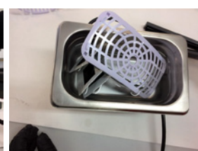
Laura Caroni (arriba) y Fernando Osorio (abajo) usan la pila ultrasónica con alcohol isopropílico. Fotos: Valeria Vega
