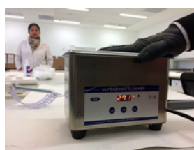
Laura Caroni (arriba) y Fernando Osorio (abajo) usan la pila ultrasónica con alcohol isopropílico. Fotos: Valeria Vega
