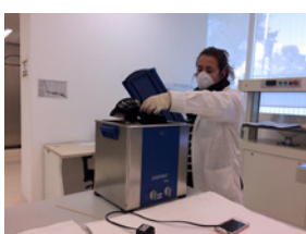
Laura Caroni (arriba) y Fernando Osorio (abajo) usan la pila ultrasónica con alcohol isopropílico. Fotos: Valeria Vega
