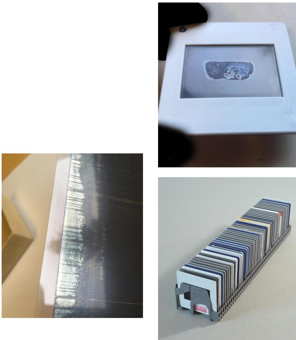
**Fig. 4:** Espejeo de la plata en placa espectroscópica (1), lixiviación en montura de cristal de diapositiva (2), rotura en placa de vidrio (3), carrusel de diapositiva sin protección (4). Fotografía: Pablo Castilla.
